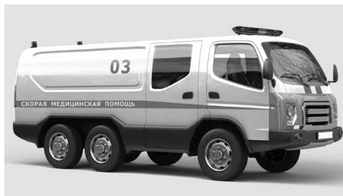
Рис. 12. Семейство пассажирских и грузопассажирских автомобилей повышенной проходимости с колесной формулой 6х6 по проекту «Бурка»: а – автобус; б – пикап с двухрядной кабиной; в – грузовой фургон; г – машина скорой помощи
